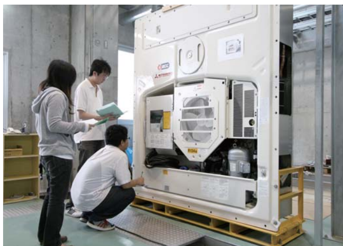
冷凍システム (船用冷凍コンテナ) の実験
