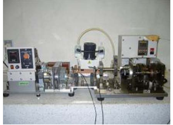
機械設備のヘルスマonitoring (状態監視と診断) 装置
