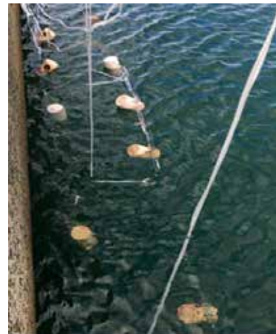
図2 海中に設置される焼成試料
