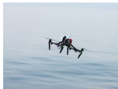
魚群を撮影するために練習船から飛び立つ自律式マルチコプター（ドローン）
