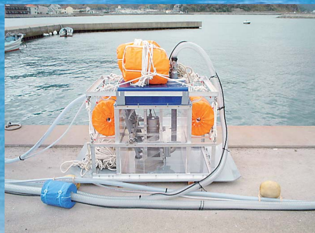
汚泥除去装置
