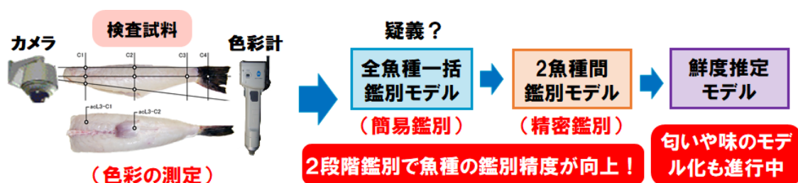
図2. フグ類身欠きの魚種等鑑別・品質推定システムのフロー
