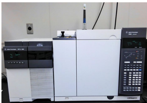
図2. GC/MS 揮発成分を分離・同定する装置.
