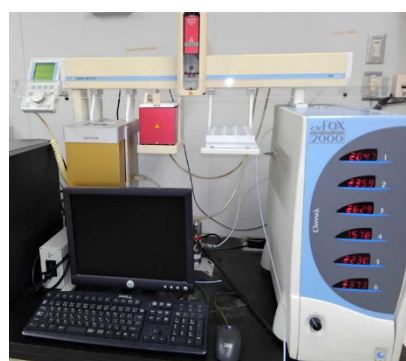
図1. 電子嗅覚装置 においの違いを識別する装置。
