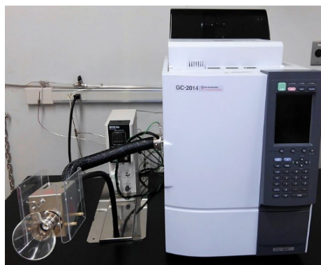
図3. におい嗅ぎ装置付き GC 分離した揮発成分のにおいを嗅ぐことができる装置.
