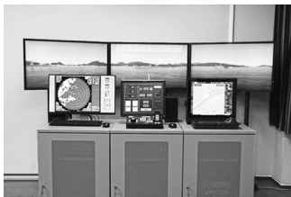
ECDISシミュレータ装置 (ビジュアル操船 シミュレータ部)
