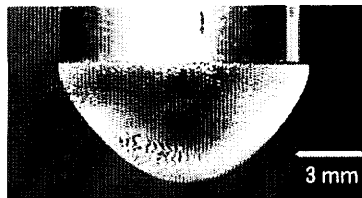
円柱型の音波放射器端面で安定に付着保持されている水
