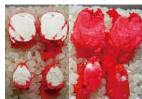
(a)処理なし (b)処理有り 衝撃波を用いたフリーズドライの前処理技術
